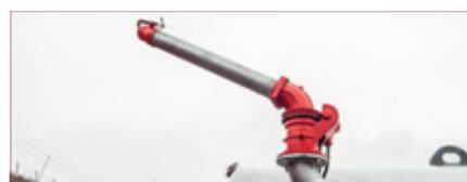
Üst atıcı, operatörlerin makineden gübreyi uzun mesafelere fırlatmalarına olanak tanıyan **opsiyonel** bir özelliktir.
