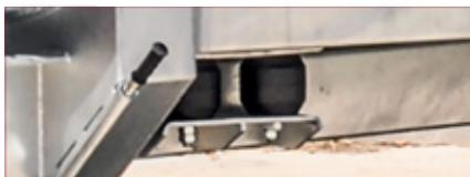
Gübre tankeri modellerinde, yükü şası ve traktör üzerinde dengelemek için kauçuk süspansiyon sistemi bulunmaktadır.
