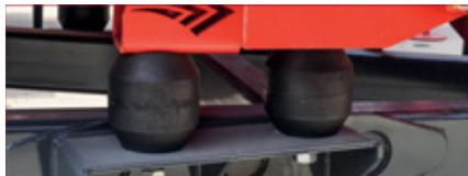
Gübre serpme makine modellerinde, yükü şasi ve traktör üzerinde dengelemek için kauçuk süspansiyon sistemi bulunmaktadır.
