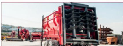
FMGR serisi gübre serpme makinelerinde özel tasarlanmış ve dengelenmiş fırlatıcılar bulunur. Bu, standart bir özelliktir.
