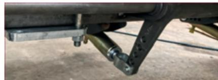
Hidrolik fren, operatörlerin traktör kabini içinden makinedeki frenleri etkinleştirmesine olanak tanıyan **opsiyonel** bir özelliktir.
