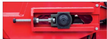
Zincir germe sistemi FMGR serisi gübre serpme makinelerine yerleştirilir. Bu sistem, operatörlerin zincir üzerindeki gerilimi ayarlamasını sağlar. Bu, standart bir özelliktir.
