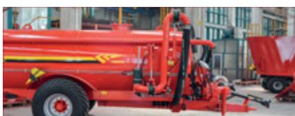
Hidrolik emme sistemi, operatörlerin traktör kabini içinden emme kolu hidrolik olarak kontrol etmelerine olanak tanıyan **opsiyonel** bir özelliktir.
