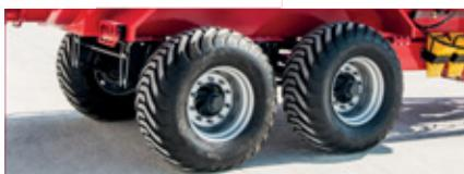
Yüzer lastikler, geniş ve yumuşak lastiklerdir ve yerdeki basıncı alanını genişletir. Yüzer lastikler, ıslak ve yumuşak zeminde çalışmayı mümkün kılar.
