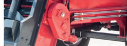
Gübre serpme makinelerinde fırlatıcılar ve konveyör sistemi için ayrı, yüksek kaliteli dişli kutuları bulunur.
