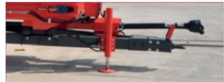
Gübre serpme makinelerinde ayarlanabilir destek ayakları bulunur. Bu standart özellik, operatörlerin makineyi kolayca depolamasına olanak tanır.
