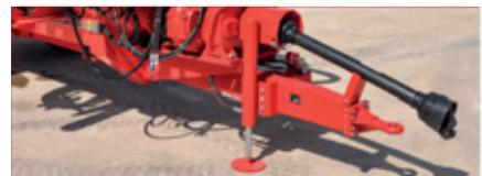
Gübre tankeri modellerinde ayarlanabilir destek ayaklıları bulunur. Bu standart özellik, operatörlerin makineyi kolayca depolamasını sağlar.
