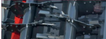
Yüksek performanslı bıçaklar fırlatıcılara yerleştirilir. Bu bıçaklar homojen yayılma için özel olarak tasarlanmıştır.
