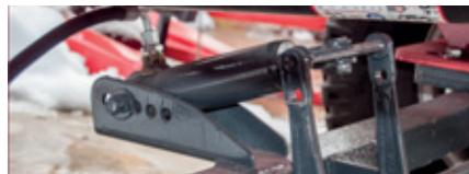
Hidrolik fren, operatörlere traktör kabini üzerinden makinedeki frenleri etkinleştirme olanağı sağlayan **opsiyonel** bir özelliktir.
