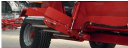
Yan konveyör operatörlerin boşaltma yüksekliğini ayarlamasına izin verir. Bu, yatay yem karma için standart bir özellik, dikey yem karma için ise **opsiyoneldir**.
